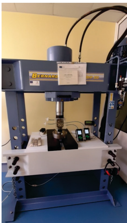
Фиг. 1. Хидравлична преса с измервателната система за изследване на емисиите на частици при едноосно деформиране на скални образци.
