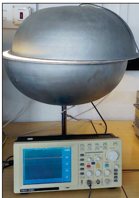
Фиг. 5. Лабораторна постановка за измерване на пулсации на светлинния поток
