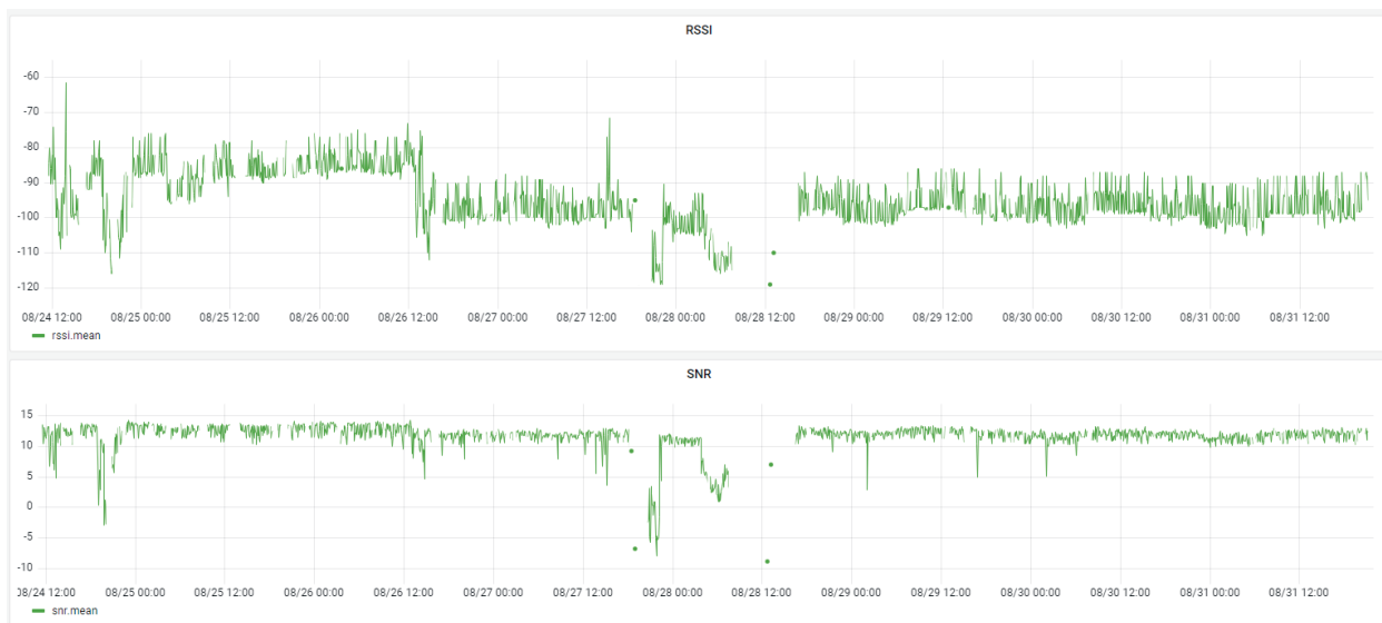
Фиг. 7. Стойности на параметрите RSSI и SNR за множеството измервания в LoRaWAN мрежата
