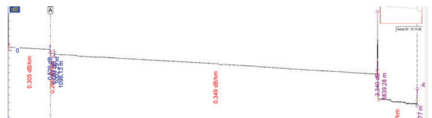
Фиг.11. Рефлектограма с двоен проблем
